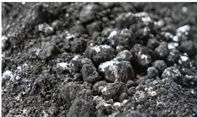
Eines der Zwischenprodukte ist Kupferbleistein, er besteht aus Kupfer, Blei, Schwefel und Edelmetallen.
